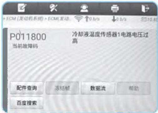
◎图 1-4-9 读取发动机故障码
