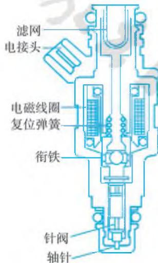
◎图 2-1-11 轴针式喷油器
