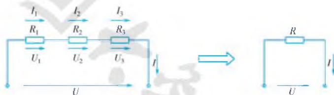
◎图 1-3-3 串联电路
