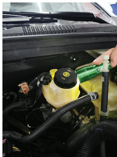
图 2-6-2 检查制动液液位
