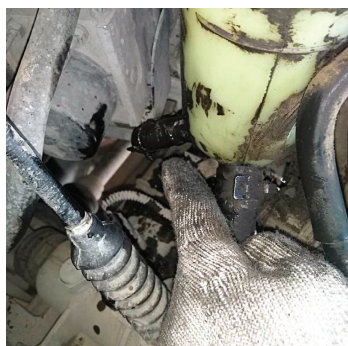
a. 用油塞将储油箱上回油管接头堵住
