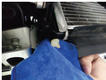
b. 散热器下水管放水螺丝
