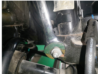
图 3-4-6 松开减震器固定螺栓
