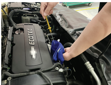
a. 再次拔出机油标尺
