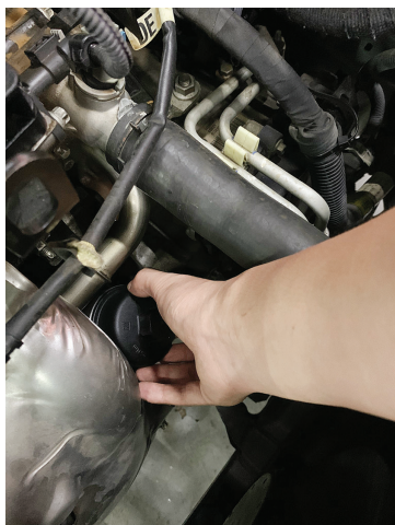
图 2-2-19 旋出机油滤清器
