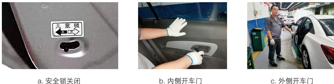
图 6-2-11 儿童安全锁关闭状态的检查
