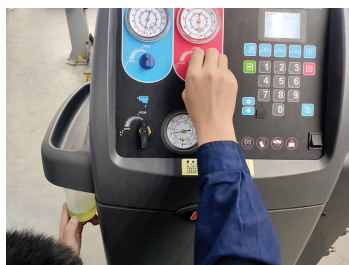
图 5-5-20 加注冷冻机油
