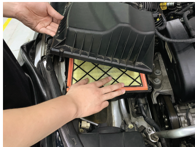
图 2-7-7 安装空气滤清器滤芯
