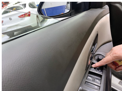
图 5-4-3 检查玻璃升降器总开关
