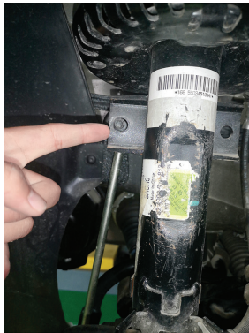
图 3-4-5 松开稳定杆固定螺栓
