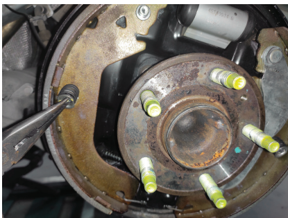
图 4-2-18 安装制动蹄摩擦片固定弹簧
