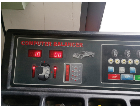
图 3-7-3 读取动不平衡量
