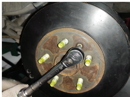
图 4-2-20 安装制动鼓固定螺栓
