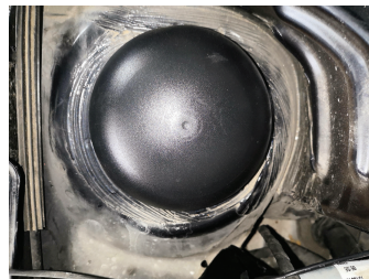
图 3-4-8 取出减震器总成顶部防尘罩
