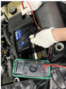
图5-1-3 测量静态电压
