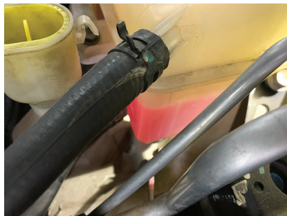
图 2-3-4 检查冷却液品质
