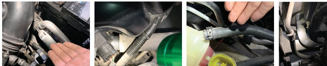
a. 检查上水管接头
