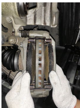
图 4-1-4 拆卸制动摩擦片
