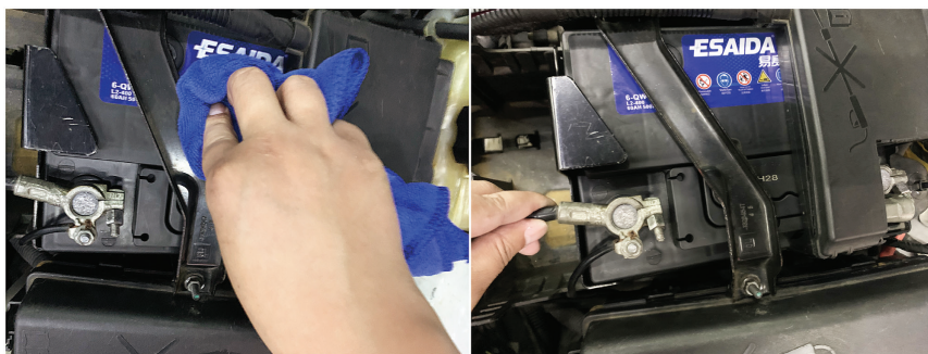
图 1-1-9 清洁蓄电池外部，检查极柱与电缆的连接情况
