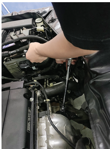
b. 用专用工具拧松机油滤清器
