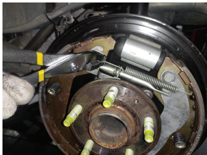
图 4-2-15 拆卸制动器调节弹簧
