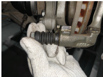
图 4-1-11 检查制动钳导销
