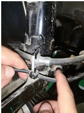
图 3-4-7 松开制动管路固定螺栓
