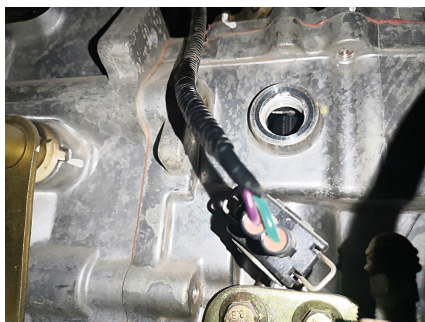
图 3-2-1 拆下变速箱注油螺丝
