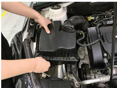
a. 安装空气滤清器上盖
