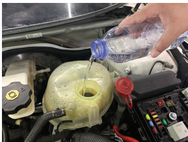
图 2-3-12 将清水倒入水箱
