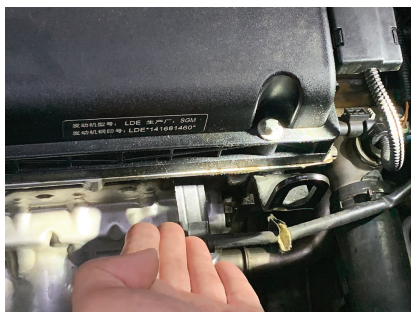
图 2-1-10 检查发动机舱内是否漏油漏液
