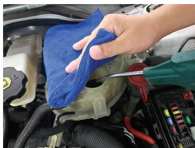
图 2-3-13 用气枪将高压空气灌入水箱
