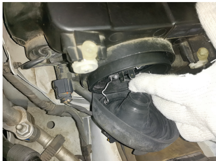
图 6-1-20 灯泡固定在反射弧内
