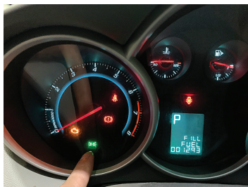
图 5-2-2 灯光开关处于示宽灯挡位
