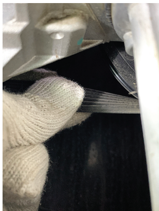
图 5-1-14 发电机的皮带检查
