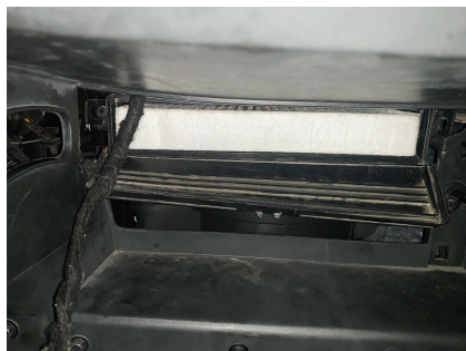
图 5-5-3 拆下粉尘滤清器
