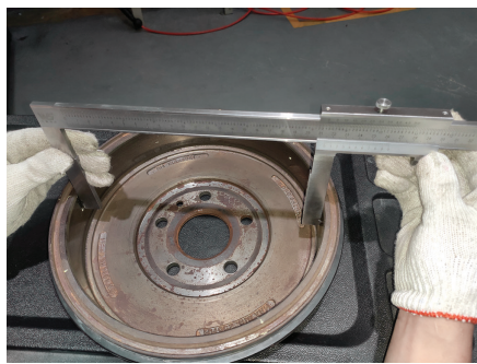
图 4-2-10 测量制动鼓内径
