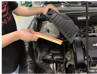
图 2-7-5 取出空气滤清器滤芯
