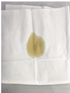
图 2-2-8 将少许新机油滴在滤纸上
