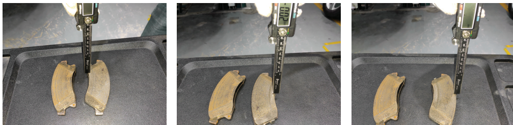
图 4-1-7 测量制动摩擦片的厚度
