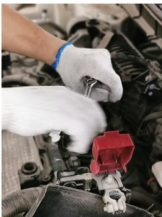
图 2-8-4 拧松点火线圈固定螺栓
