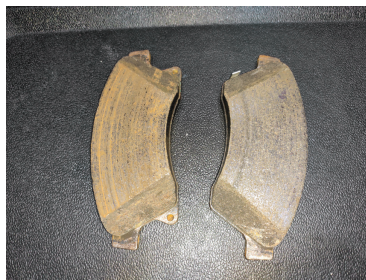
图 4-1-6 检查制动摩擦片
