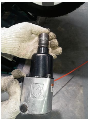
图 3-8-3 判断风炮旋转方向
