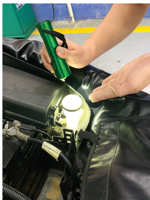
图 2-1-8 检查挡风玻璃清洗液液位
