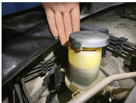
图 2-5-13 助力转向油加到储油箱上的规定刻度线处
