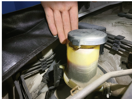
图 2-5-3 检查助力转向油液位
