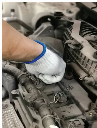
图 2-8-3 拔下点火线圈线束接头
