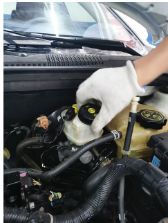
图 2-6-1 制动液储液罐安装位置
