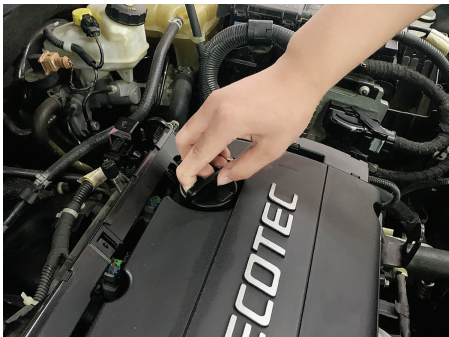
图 2-2-11 拧松机油加注口盖
