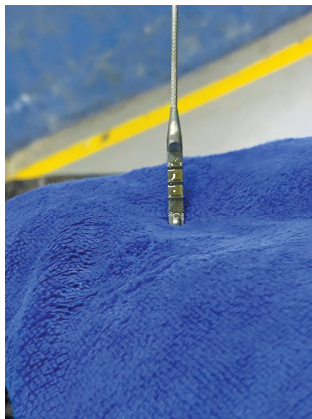
图 2-1-9 检查发动机机油液位
