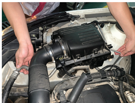
图 5-5-13 检查高低压管路温差
