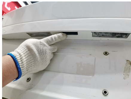
图 6-3-3 机械方式打开行李厢
