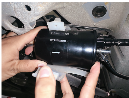
图 3-3-7 确认燃油滤清器方向
