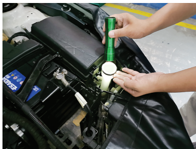
图 2-4-2 检查玻璃清洗液液面高度
