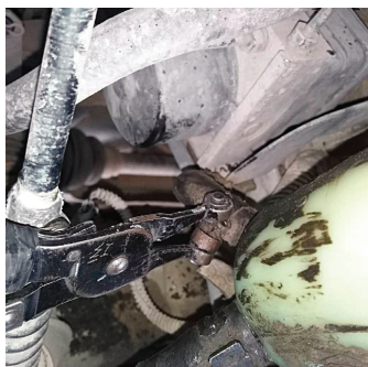
图 2-5-12 回油管接回到储油箱上
