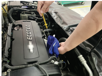
a. 拔出机油标尺
