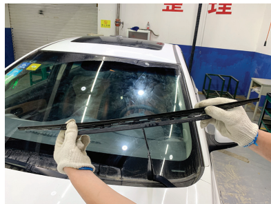
图 5-3-7 检查刮水刷片和刮水刷臂
