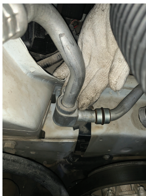
图 5-5-7 检查空调管路
