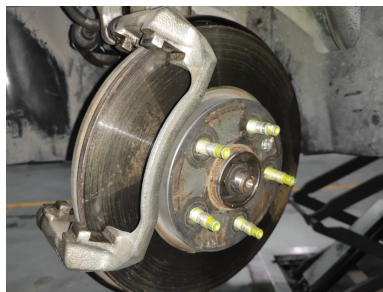
图 4-1-9 检查制动钳是否损坏
