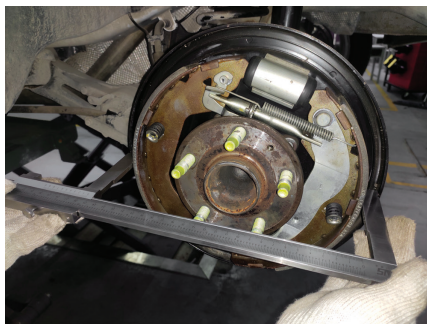
图 4-2-11 测量制动蹄直径
