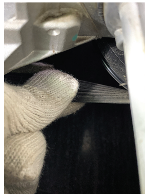
b. 检查皮带张紧度
