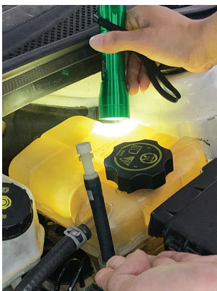
图 2-1-7 检查发动机冷却液液位
