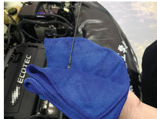
c. 将机油标尺插回油底壳
