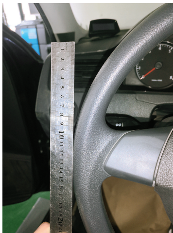
图3-5-6 测量转向盘的自由行程
