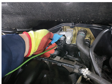
图 5-5-25 连接压力传感器
