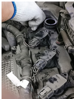
图 2-8-8 安装点火线圈
