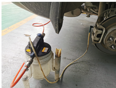
b. 塑料软管插入接油容器
