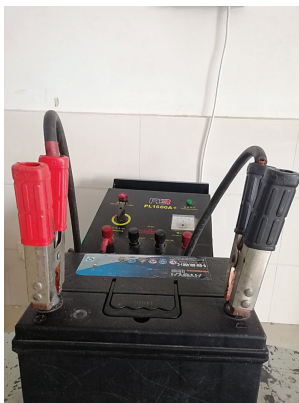
图 5-1-11 连接蓄电池和充电机
