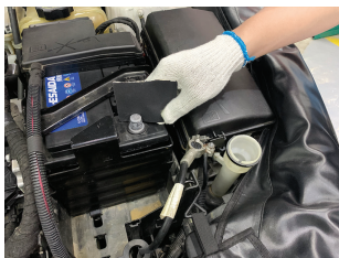
图5-1-5 打磨蓄电池极桩
