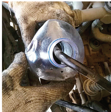
图 2-5-9 将储油箱和油管中的油液排放到容器中
