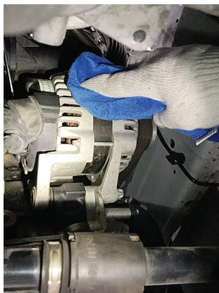
图 5-1-13 发电机的基本检查
