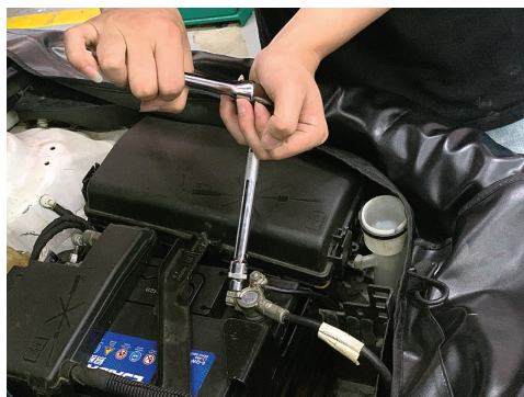
图 2-8-10 安装蓄电池负极
