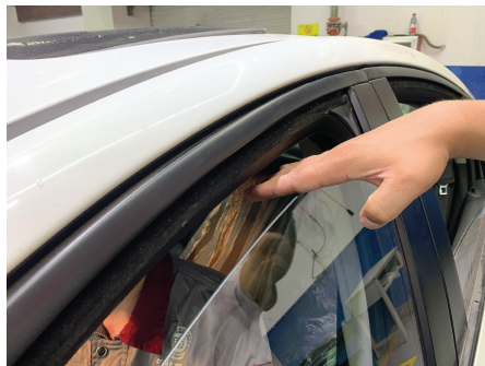
图 5-4-5 检查玻璃升降器防夹功能
