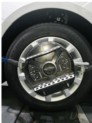
图 3-8-7 安装夹具和探测头
