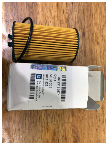
图 2-2-20 拆封新机油滤清器
