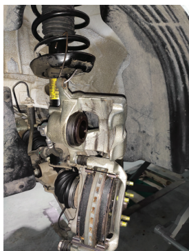
图 4-1-3 推开制动钳壳体
