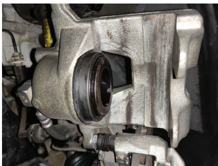
图 4-1-10 检查制动浮钳外观
