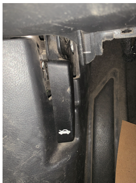
图 2-1-5 拉动发动机舱盖拉手
