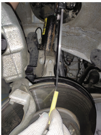
图 4-1-13 对制动盘进行测量位置标记
