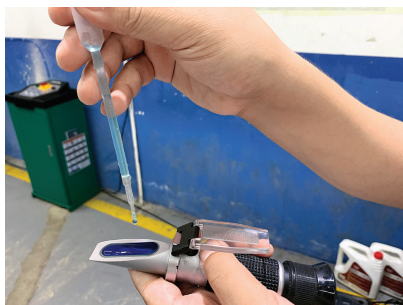
a. 冷却液滴在冰点仪镜片上
