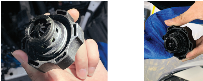
a. 检查散热器盖密封圈
