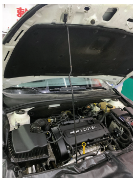
c. 支撑发动机舱盖
