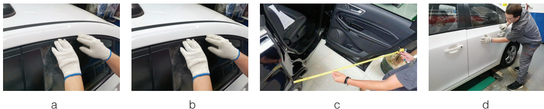
图 6-2-8 车门关闭时检查
