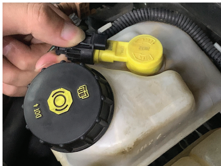
图 2-6-8 拔下液位传感器插接器
