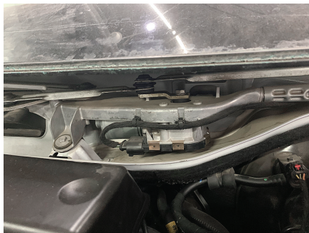
图 5-3-8 检查刮水器电机有无异响
