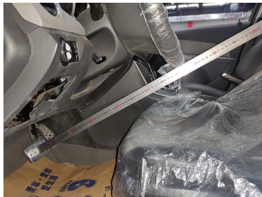
图4-3-1 测量制动踏板到转向盘轮缘的距离
