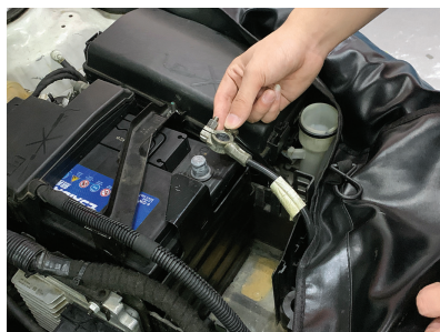
图 2-8-2 拆卸蓄电池负极
