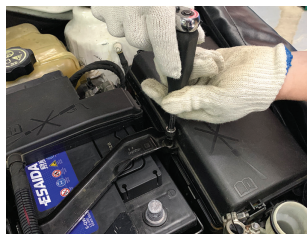
图5-1-6 检查蓄电池支架固定螺栓
