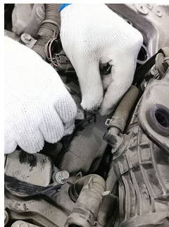
图 2-8-9 安装点火线圈线束、盖板
