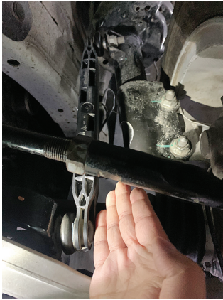
图 1-1-2 检查转向装置
