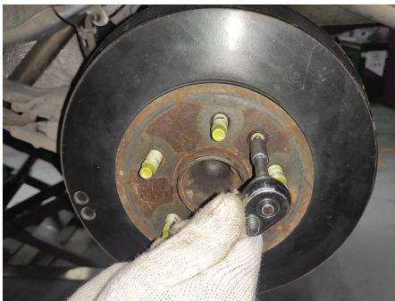
图 4-2-7 拆下制动鼓固定螺栓
