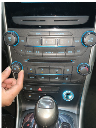
图 5-5-9 打开空调（温度、风量、A/C 开关）
