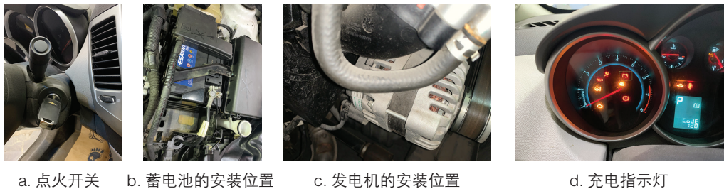
图 5-1-1 电源系统的组成及安装位置
