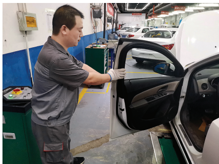
图 6-4-5 晃动车门使润滑油脂渗入
