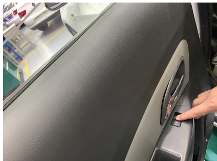
图 5-4-4 检查玻璃升降器单侧开关
