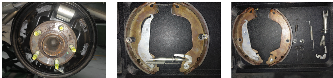
图 4-2-17 组装制动蹄摩擦片
