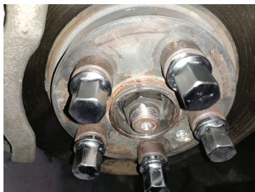
图 4-1-15 安装锥形垫圈
