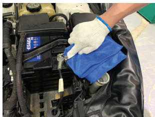
图5-1-4 清除连接线及夹头的脏污
