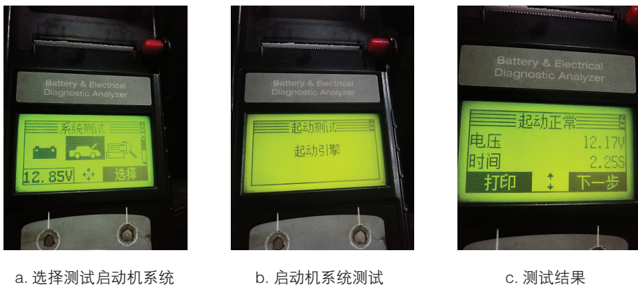
图 5-1-9 启动系统电压检测
