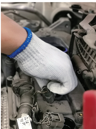
图 2-8-5 取出点火线圈
