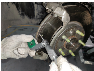
图 4-1-14 测量制动盘厚度
