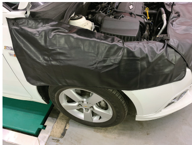
a. 安装两侧翼子板布
