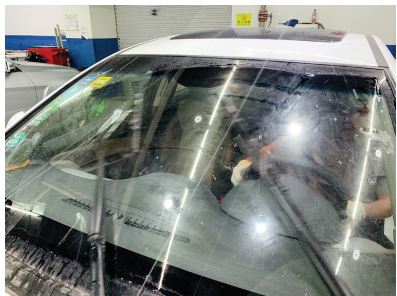
图 5-3-6 刮水器挡位检查
