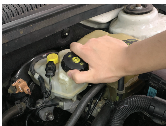
a. 拧松制动液储液罐的加液盖口
