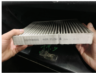
图 5-5-5 安装粉尘滤清器
