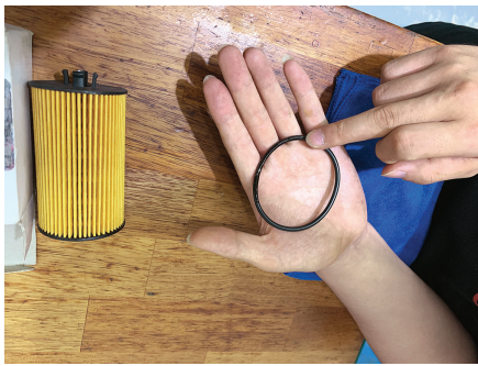
a. 滤清器密封圈处涂抹机油
