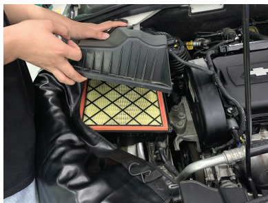
图 2-7-4 掀起空气滤清器上盖
