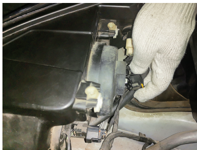
图 6-1-17 拔下灯泡电源插头
