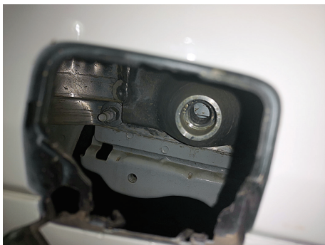
图 6-1-24 检查拖车钩和螺牙配合情况
