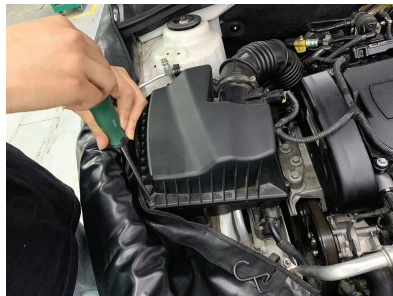
图 2-7-3 拆下空气滤清器上盖
