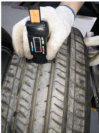
图 3-8-5 检查轮胎花纹深度
