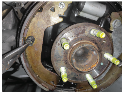
图 4-2-16 拆卸制动蹄摩擦片固定弹簧
