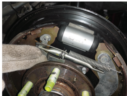
图 4-2-14 检查制动器调节弹簧
