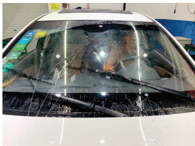
图 5-3-4 刮水器运动及喷水检查
