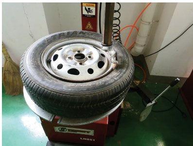
图 3-7-7 拆装器接触轮辋边缘
