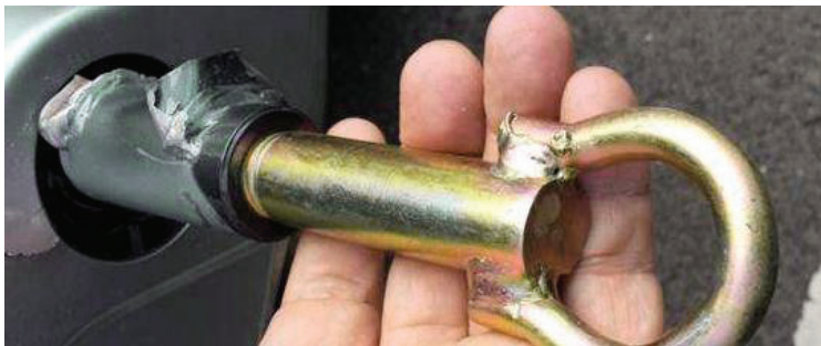
图 6-1-23 取出拖车钩并检查
