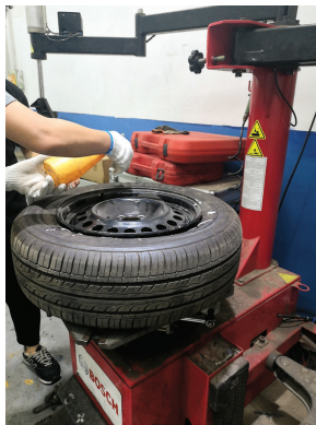
图 3-7-8 轮辋边缘涂抹少量的润滑剂
