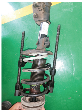
图 3-4-10 专用工具拆卸减震器
