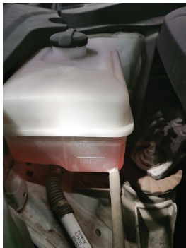
图 2-3-16 加注冷却液到最高刻度线处
