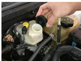
b. 取下制动液储液罐加液盖口
