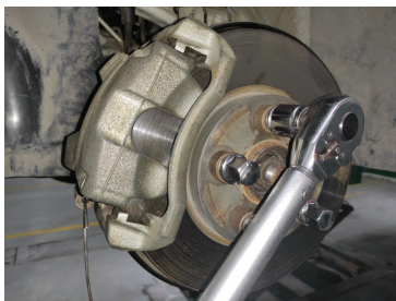
图 4-1-16 安装车轮螺栓
