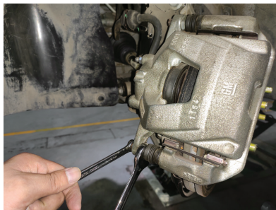
图 4-1-2 拧下制动钳导销螺栓
