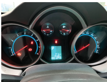
图 5-2-1 点火开关处于“ON”挡显示屏显示
