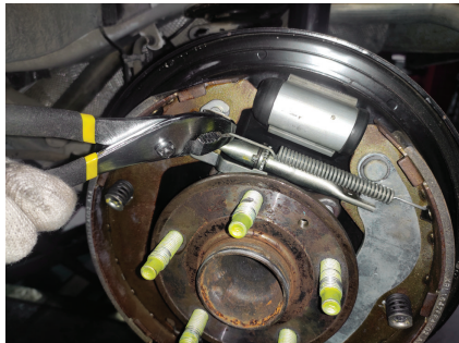
图 4-2-19 装复制动器调节弹簧
