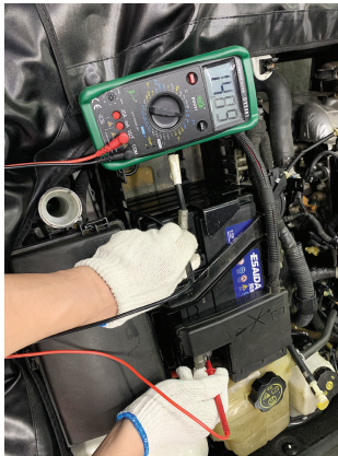
5-1-15 电源系统的动态测量
