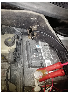
图5-1-7 连接蓄电池数字检测仪
