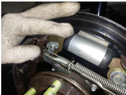
图 4-2-13 检查制动分泵各部件
